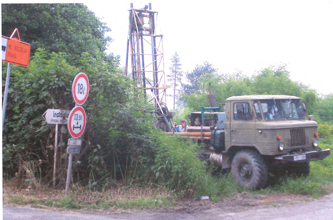
Obr. 1 Vrtná souprava UGB 50 – 1 VS při realizaci vrtu J 1.
