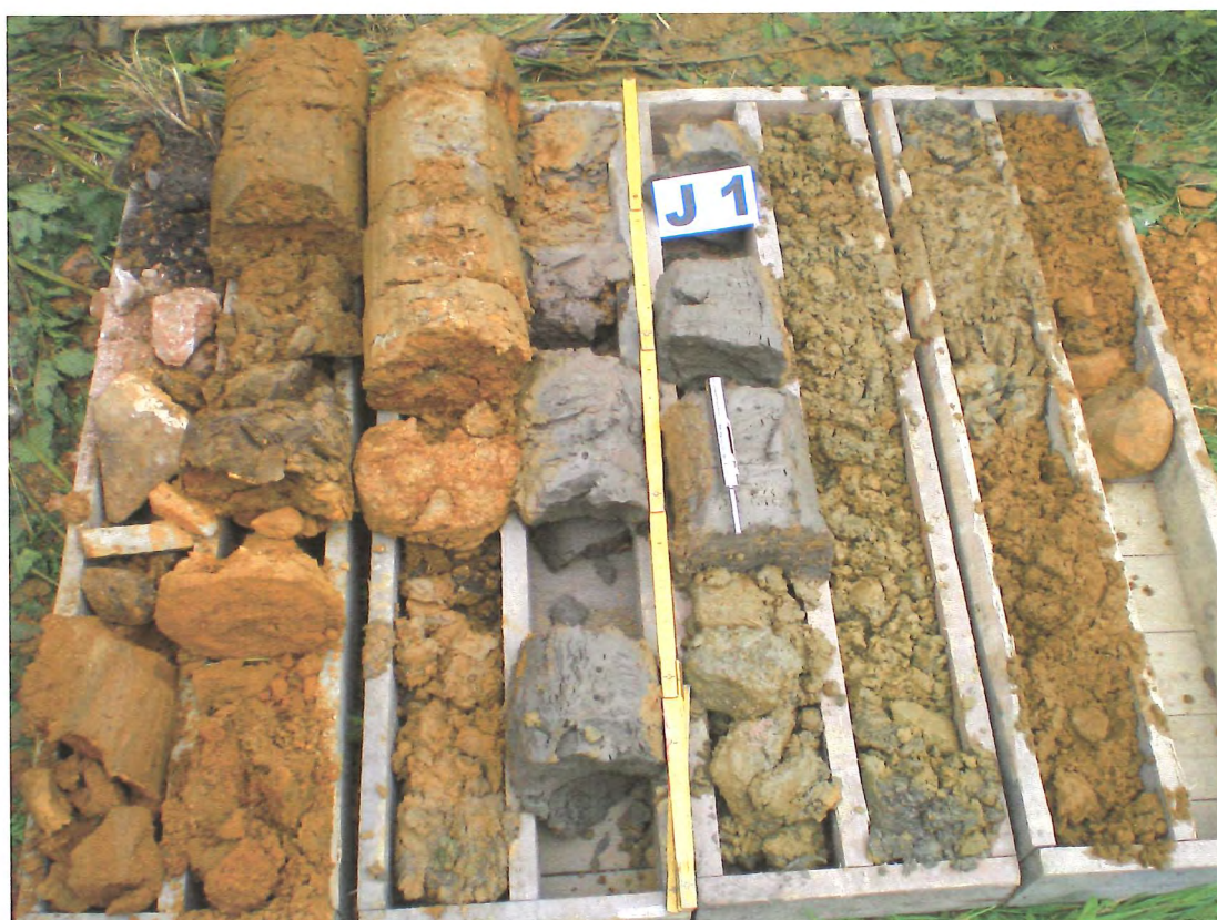
Obr. 2 Vzorkovnice s jádrem z vrtu J 1, hl. 0,0 – 7,5 m. Povrch terénu je v levém horním rohu, kamenité navážky končily v 0,7 m a písčito-jílovité holocénní náplavy Svémyslického potoka ve 4,7 m. Níže se nacházely sedimenty labské terasy s erozní bází 7,2 m. Navazoval svrchnokřídový pískovec , který byl do 7,3 m písčité rozložený a hlouběji slabě navětralý až zdravý.
